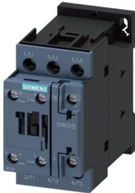
contactor de potencia, AC-3e/AC-3, 12 A, 5,5 kW/400 V, tripolar, 24 V AC, 50/60 Hz, contactos auxiliares: 1 NA + 1 NC, borne de tornillo, tamaño: S0
