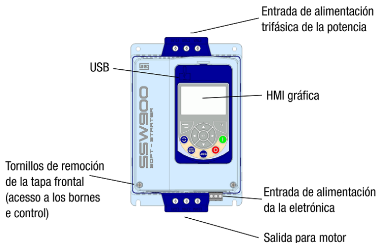
Figura 2.1: Vista frontal del SSW900
